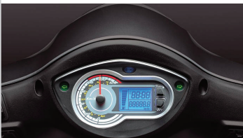
Πίνακας οργάνων με αναλογικές και ψηφιακές ενδείξεις
